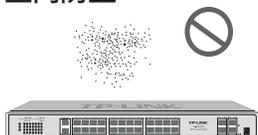
灰尘落在交换机表面会造成静电吸附，使金属接点接触不良。虽然设备本身在防静电方面做了一定措施，但当静电超过一定强度时，仍会对内部电路板上的电子元器件造成致命的破坏，为避免静电影响设备正常工作，请注意以下事项：
