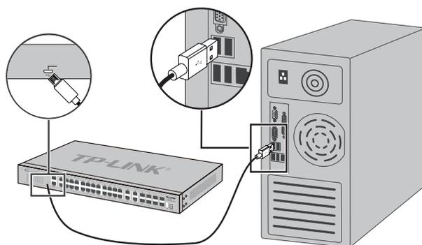
图3-4 Micro USB Console端口连接示意图
