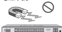
电磁干扰会以电容耦合、电感耦合、阻抗耦合等传导方式对设备内部的电容、电感等电子元器件造成影响，为减少电磁干扰因素造成的不利影响，请注意以下事项：
