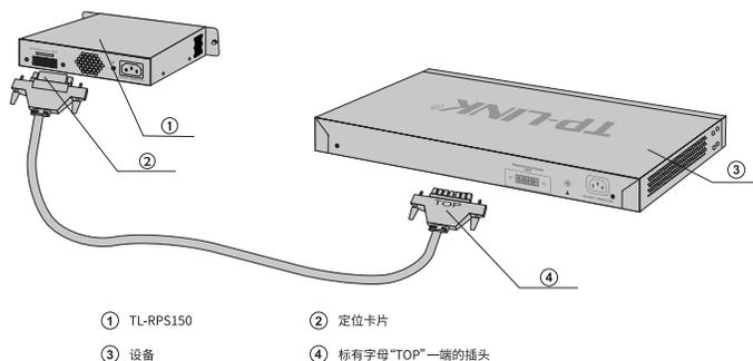
图3-6 连接设备和TL-RPS150示意图
